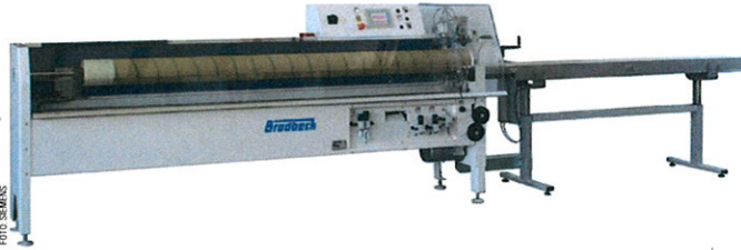
Umfassende Funktionalität auch ohne speicherprogrammierbare Steuerung: Die Rollenschneidmaschine CombiCut A der Firma Brodbeck nutzt die Rechenleistung des Antriebs für die Automation
