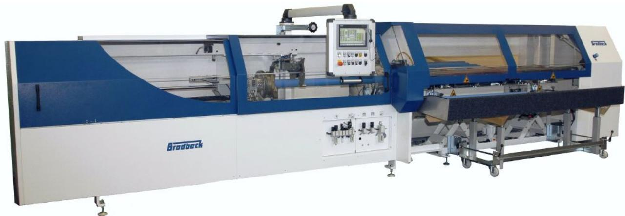
Die Maschine teilt die Rohre
